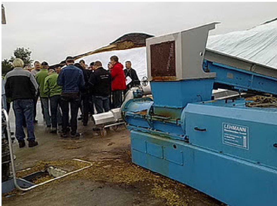
Fig. 1: Eksempel på ekstruder. Den fysiske udformning kan være forskellig fra producent til producent.
